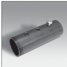
Рис.5-3: Формовка отверстия трением в круглой трубе
