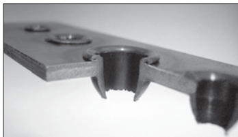
Рис. 10-1: Отверстие с обрамляющим буртиком, сформированное коротким или удлиненным пуансоном
