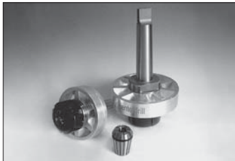
Рис. 11-2: Патроны с охлаждающим диском
