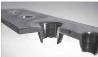
Рис. 10-2: Отверстие без обрамляющего кольца, сформированное торцующим пуансоном Centerdrill
